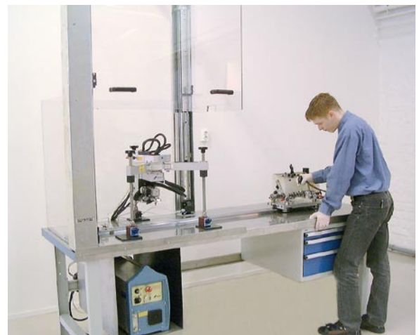
Ätztisch zur Tiefenprofilerstellung
