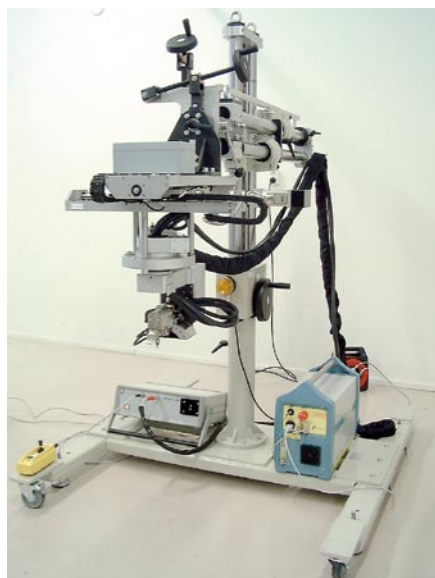
Координатный стол с автоматизированным управлением, исполнение для напольной стойки
