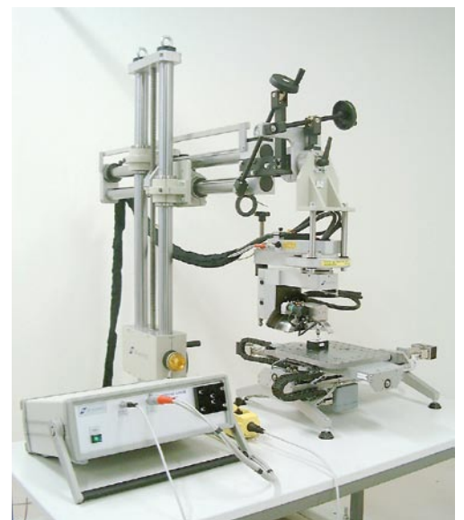
Координатный стол с автоматизированным управлением, настольное исполнение
