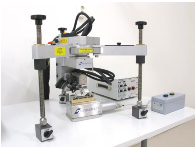
Система для определения модуля упругости рентгеновским методом
