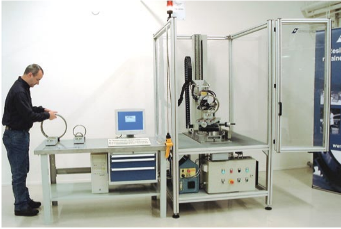
Рентгеновский стенд для проверки обойм подшипников
